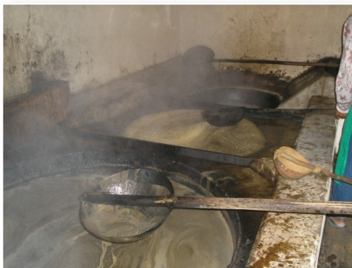
FIGURA 45 – ESPUMA DO CALDO SENDO RETIRADO
