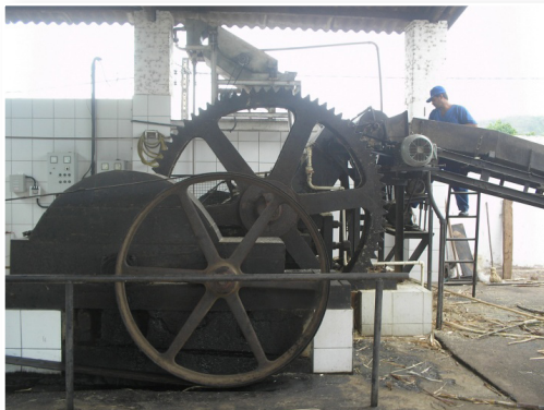
FIGURA 34 – PROCESSO DE EXTRAÇÃO DO CALDO.
