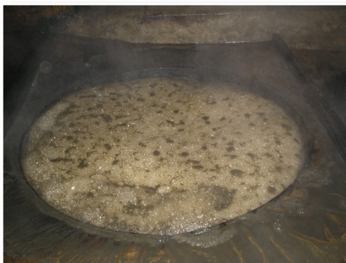
FIGURA 46 – PROCESSO DE LIMPEZA DO CALDO
